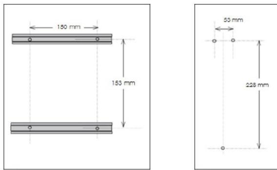
2. Установите первый инвертор на рельсы с помощью клемм подключения солнечных батарей. Сдвиньте фиксирующий зажим, прилагаемый к устройству, вниз. Повесьте устройство на верхнюю направляющую. Сдвиньте стопорный зажим вверх, чтобы устройство удерживалось на нижней направляющей. Устройство закреплено на месте.
